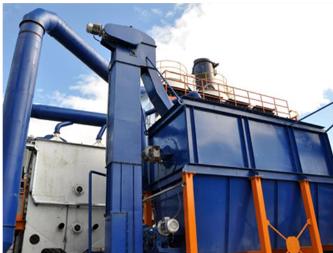
Слика 11. Стабилизатор, спремик и врећасти филтер систем
