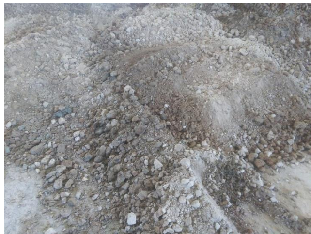
Слика 6. Припрема чврстог отпада – млевење отпадне филтер погаче
