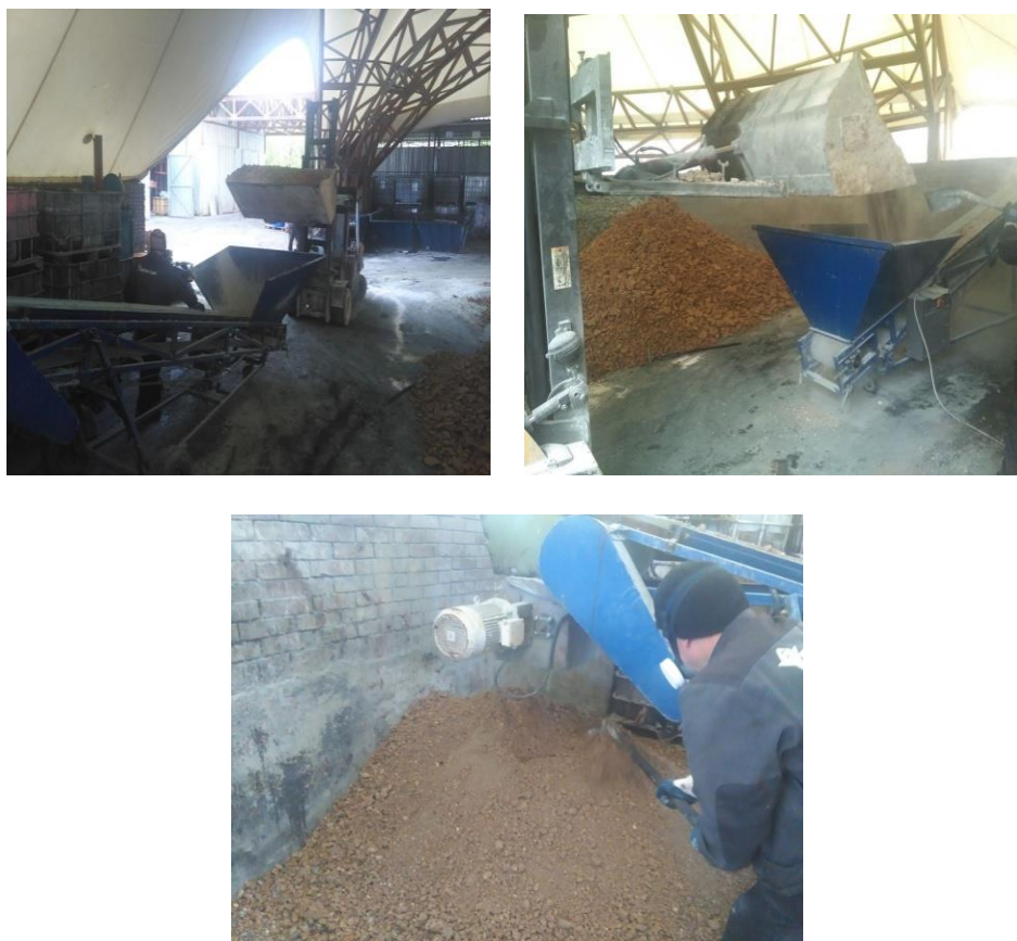
Слика 7. Бокс за чврсти отпад са тракастим транспортером и редлером
