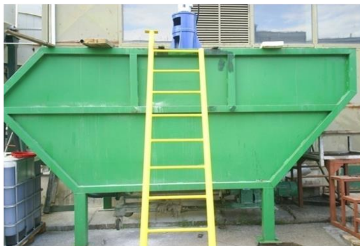
Слика 5. Контејнер за течни отпад са мешачем и вијчаном пумпом
