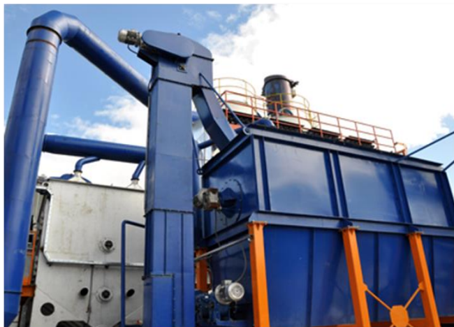
Слика 11. Стабилизатор, spremник и врећасти филтер систем
