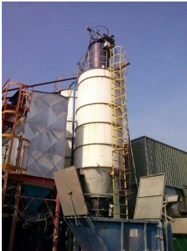
Слика 15. Силос за калцијум оксид са отпрашивачем
