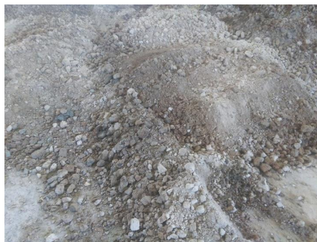
Слика 6. Припрема чврстог отпада – млевење отпадне филтер погаче
