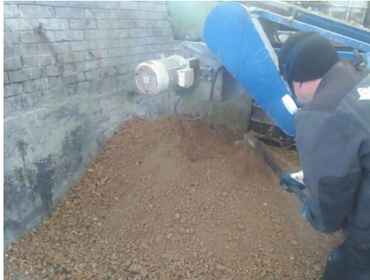
Слика 7. Бокс за чврсти отпад са тракастим транспортером и редлером
